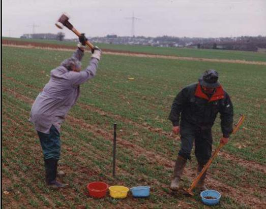
Probenahme mit Pürckhauer-Bohrstock bis 90 cm Tiefe
